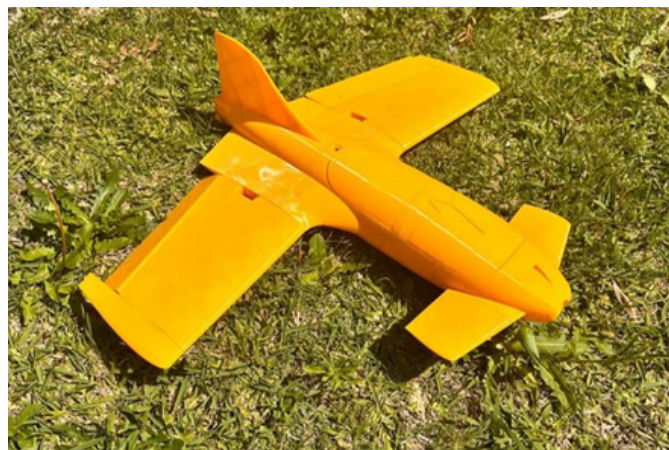
FIG.3 FUSELAJE DE AERONAVE NO TRIPULADA IMPRESO EN 3D (ELABORACIÓN PROPIA).
