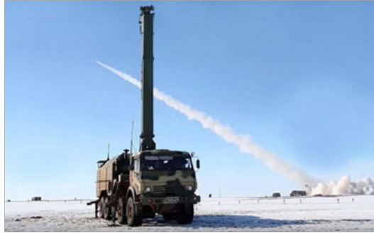
Sistema Penicillin (Rusia), montado sobre un camión KamAZ con su mástil telescópico desplegado, que integra los sensores acústicos, sísmicos y térmicos.
